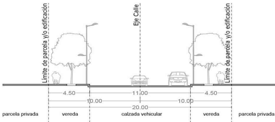
Fig. 10: Sección transversal de Vías Calles Tipo 7.
