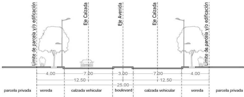
Fig. 8: Sección transversal de Vías Avenidas Tipo 5.
