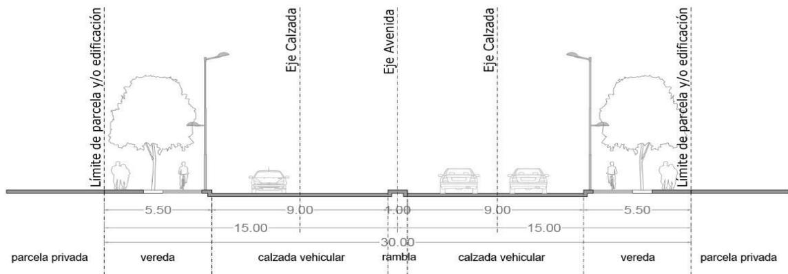
Fig. 4: Sección transversal de Vías Avenidas Tipo 1.
