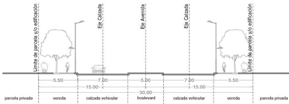
Fig. 7: Sección transversal de Vías Avenidas Tipo 4.
