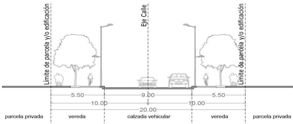
Fig. 11: Sección transversal de Vías Calles Tipo 8.
