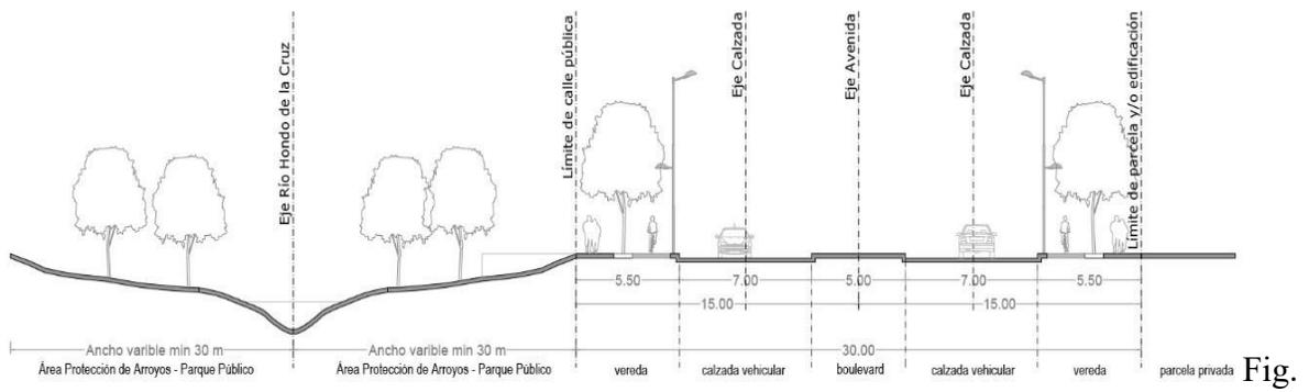
Fig. 15: Sección transversal de Vías Especiales Tipo 2.
