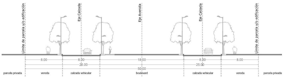
Fig. 5: Sección transversal de Vías Avenidas Tipo 2.
